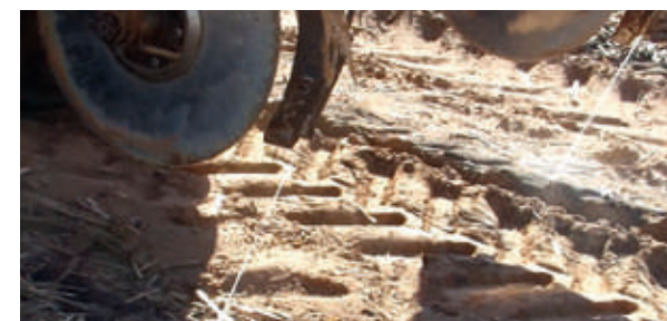
Aplicação do inseticida alinhado com os discos de corte
