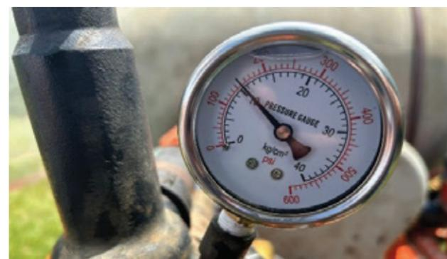
Figura 2. Regulador de pressão e manômetro no turbopulverizador.
